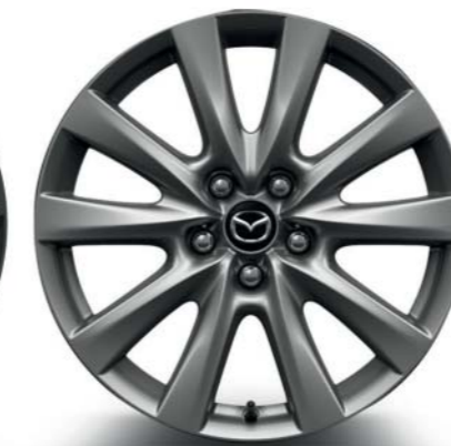
18" lichtmetalen velgen 'Silver' met bandenmaat 215/45R18 op SKYDRIVE, HAKONÉ & SKYCRUISE (enkel op Sedan e-Skyactiv G)
