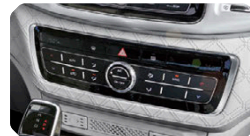
Volautomatische airconditioning in twee zones
