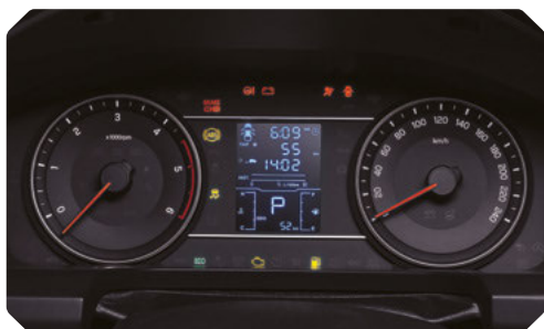
Instrumentenpaneel met boordcomputer en 3,5" TFT-scherm
