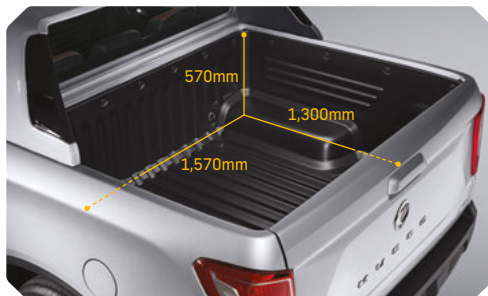
Afmetingen van de laadbak
