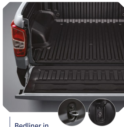
Bedliner in de open laadbak, met bindringen en stroomvoorziening
